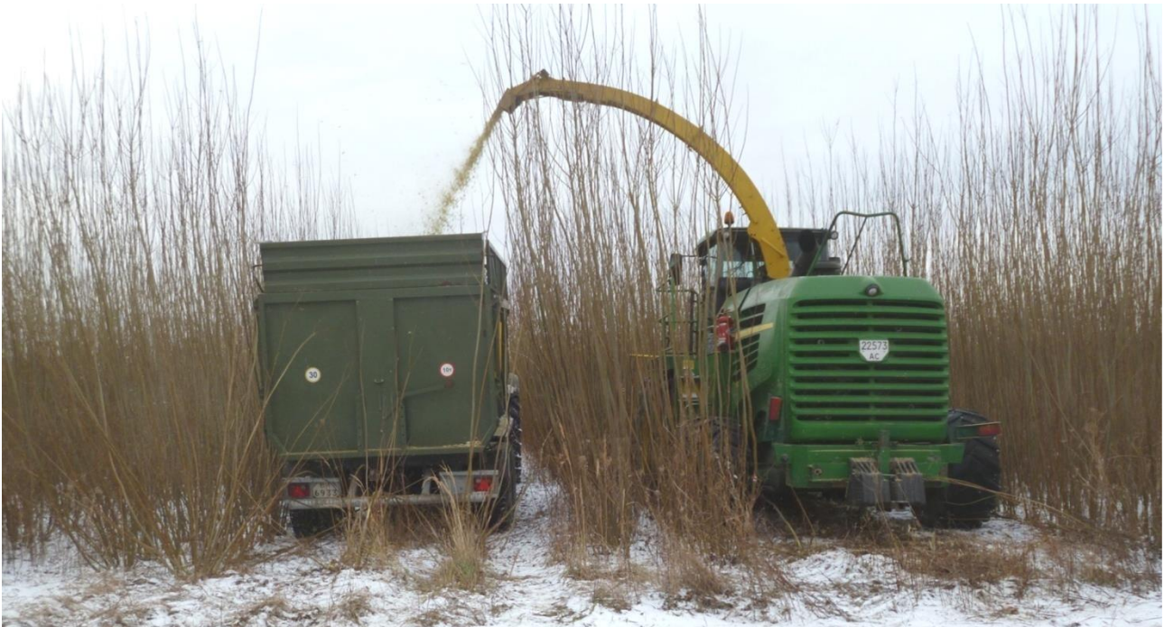
Рис. 3. Заготівля вербової енергетичної сировини з подрібненням її на тріску
