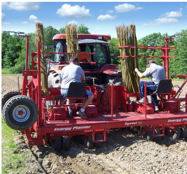
Рис. 1. Машина Energy Planter для садіння живців верби
